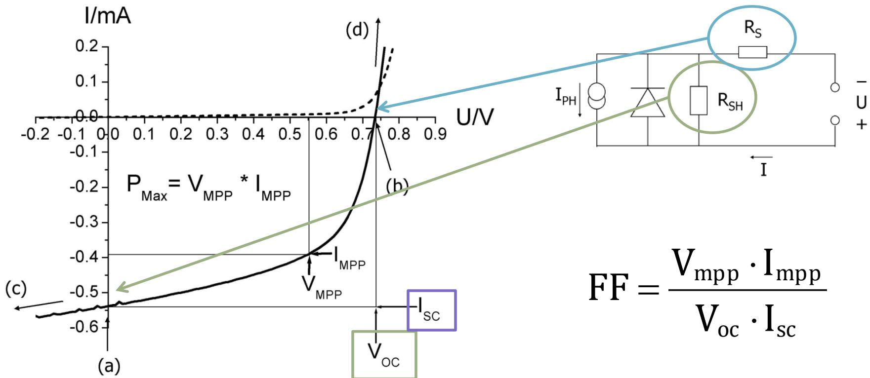
$$FF = \frac{V_{mpp} \cdot I_{mpp}}{V_{oc} \cdot I_{sc}}$$
