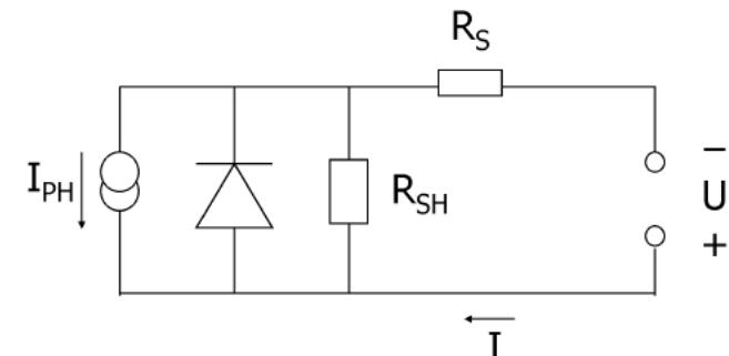
$$\text{FF} = \frac{V_{\text{mpp}} \cdot I_{\text{mpp}}}{V_{\text{oc}} \cdot I_{\text{sc}}}$$
